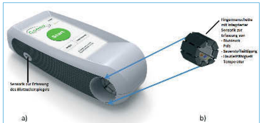
Abb. 6: a) Telemedizinisches All-In-One-Medizingerät, wie es vom Heinz Nixdorf-Lehrstuhl für Medizinische Elektronik in Kooperation mit der Fachgruppe Produktentstehung, Heinz Nixdorf Institut, Universität Paderborn, entwickelt wurde. Design: Abteilung für Industrial Design der Kunstuniversität Linz von Prof. Axel Thallemer; b) Sensormanschette im Detail ■
