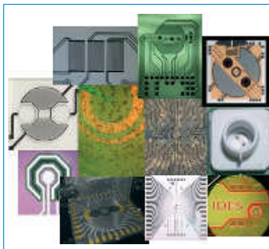
Abb. 1: Palette der am HNLME entwickelten Sensor-Chips (in Silizium-, Glas-, Keramik- und Drucktechnologie hergestellt) für den Einsatz in der Bioanalytik ■
